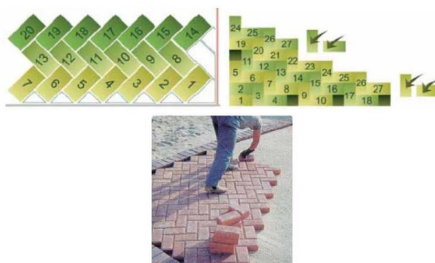
Figura 15: Padrão de assentamento tipo espinha de peixe.
