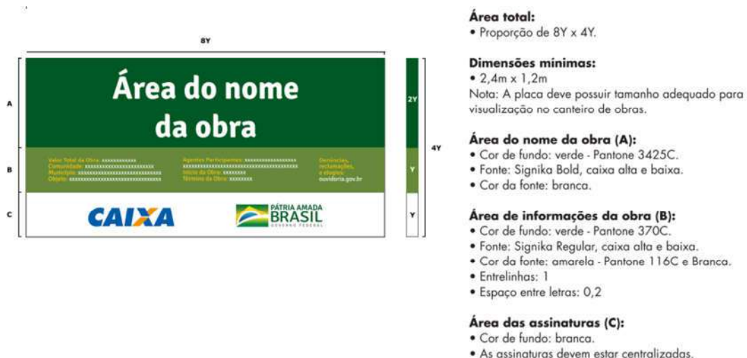
Figura 3 - Modelo de Placa de Obra
