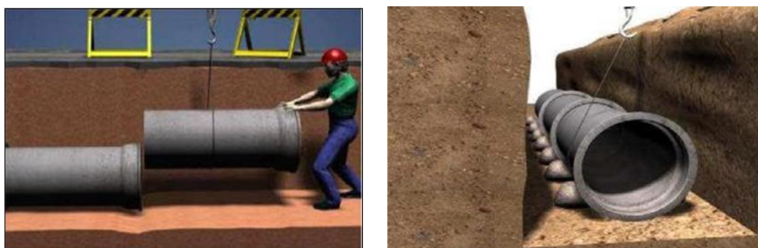
Figura 9 Acoplamento e alinhamento dos Tubos com uso de calços
