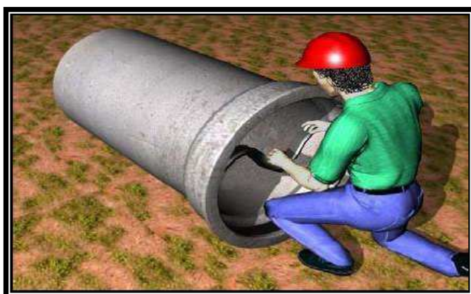
Figura 16 - Colocação do anel de borracha
