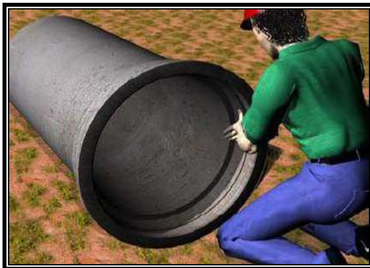
Figura 12 - Lubrificação do anel de borracha
