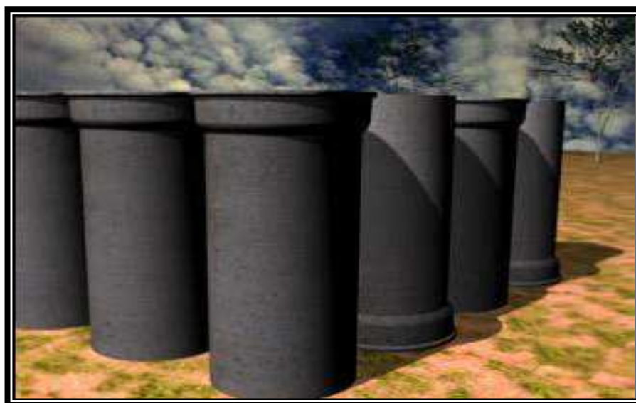
Figura 10. Tubos estocados na posição vertical
