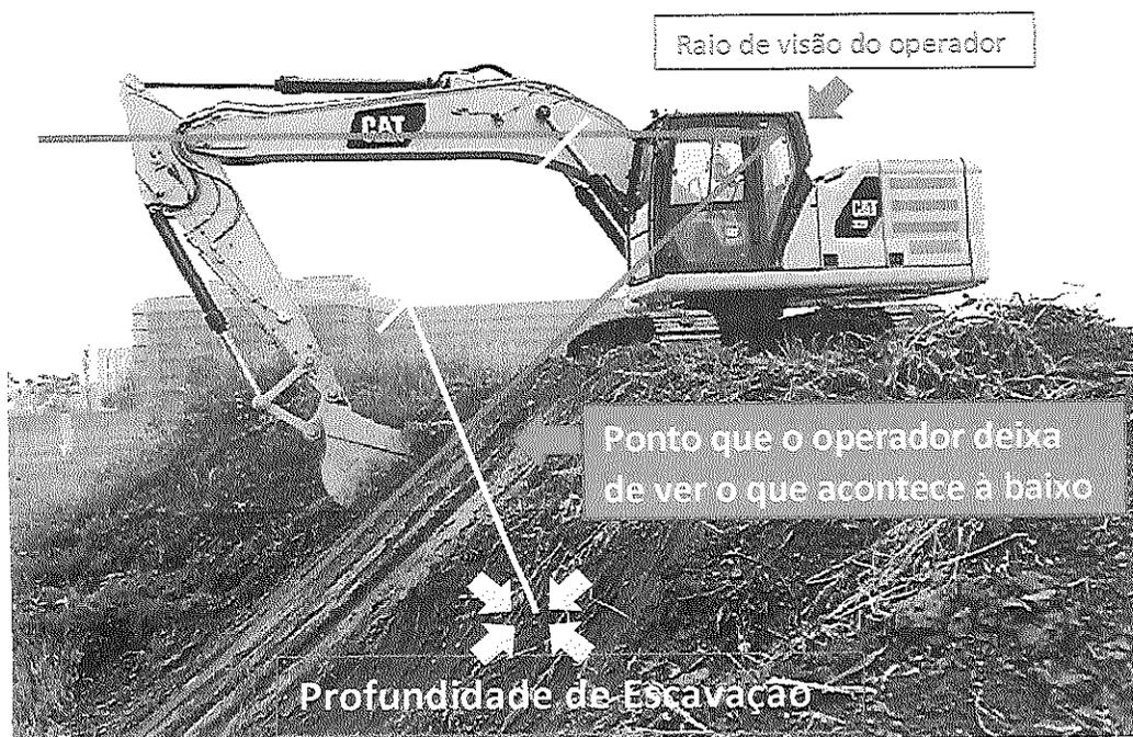
Portanto, o operador não consegue ver o que está acontecendo na “profundidade máxima de escavação” e todas as máquinas do mercado, dentro da mesma categoria, possuem idêntica profundidade de escavação, motivo pelo qual, 3 (três) insignificantes centímetros não fazem qualquer diferença para o desempenho e produtividade do equipamento, sendo tal exigência do edital excessiva e ilegal, conforme a *Lei do Pregão*:
