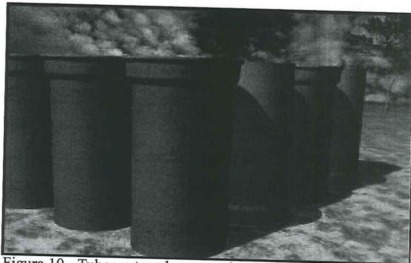
Figura 10 - Tubos estocados na posição vertical
