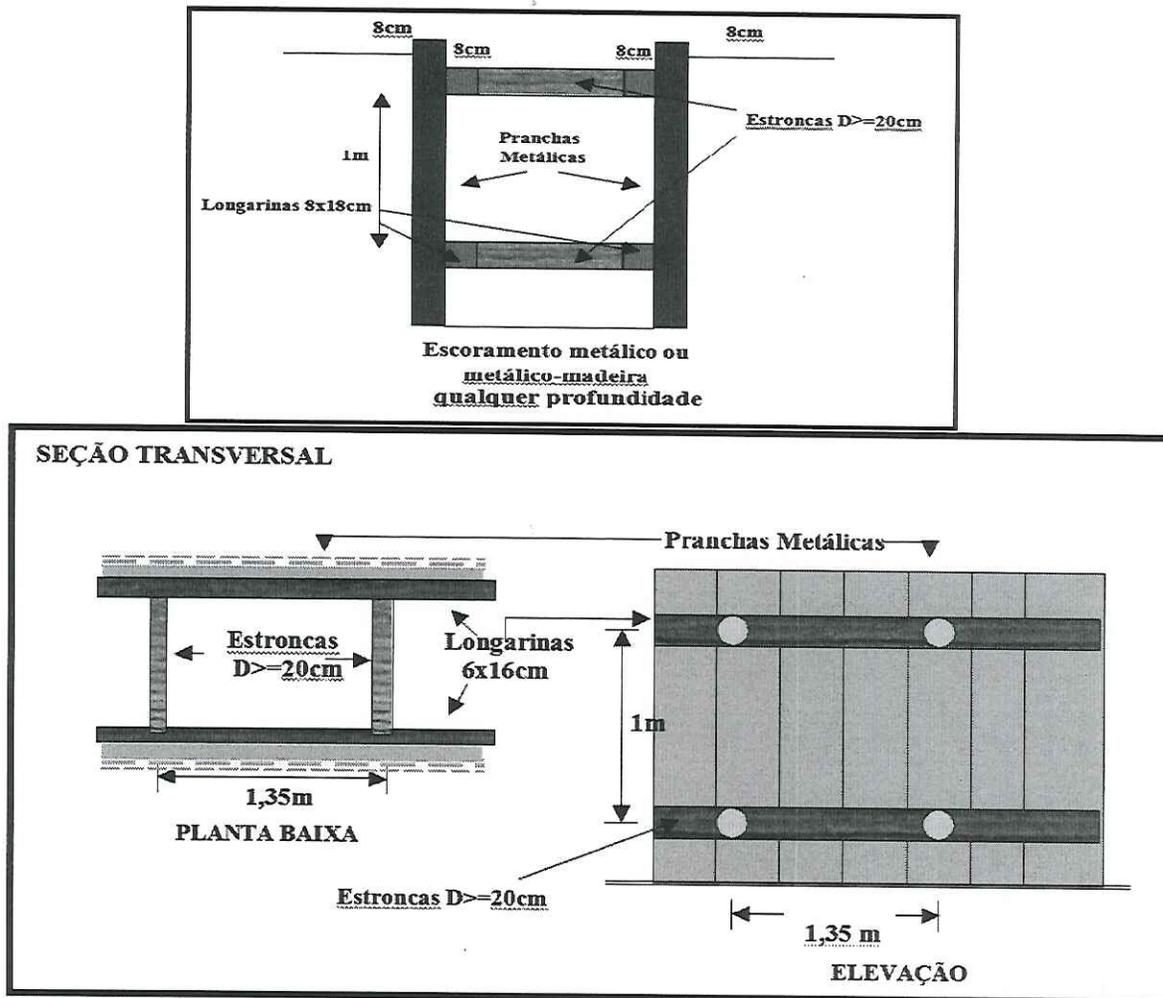
Figura 10 - Escoramento Contínuo Metálico- Madeira
