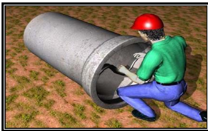
Figura 17 - Colocação do anel de borracha
