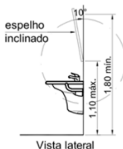
Instalação do espelho WC's PNE
