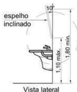
Instalação do espelho WC's PNE
