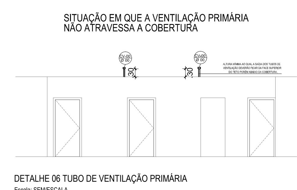
DETALHE 06 TUBO DE VENTILAÇÃO PRIMÁRIA Escala: SEMESCALA
