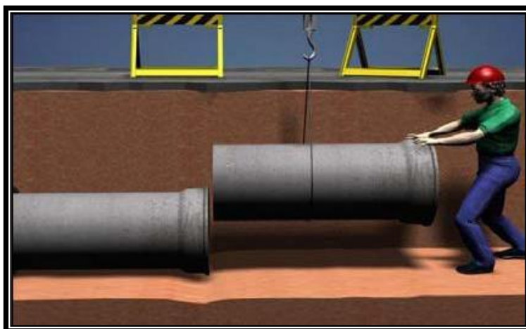
Figura 14 – Acoplamento de tubos de concreto
