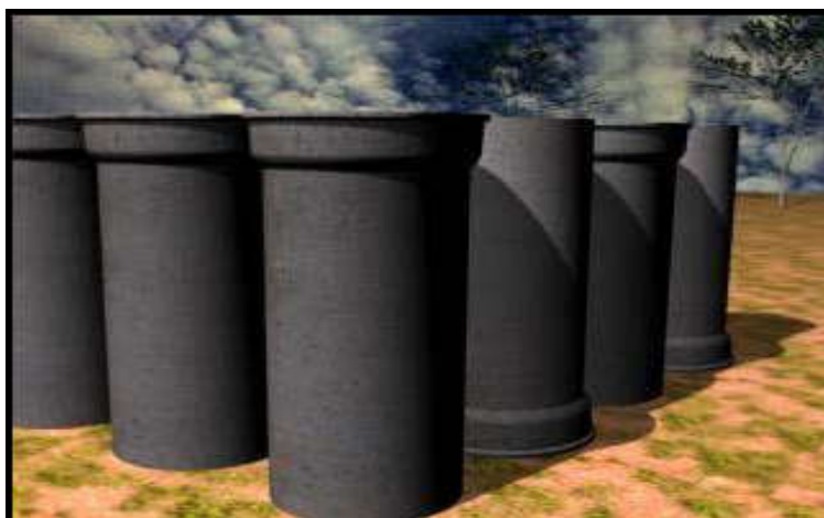
Figura 6 - Tubos estocados na posição vertical
