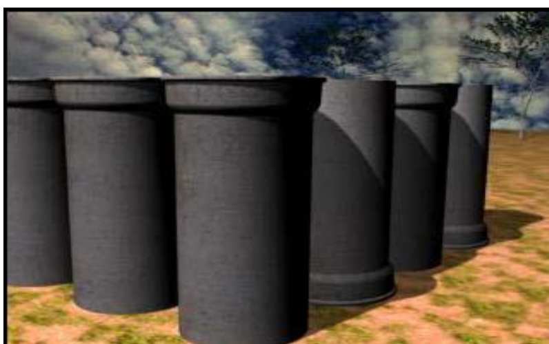
Figura 12 - Tubos estocados na posição vertical
