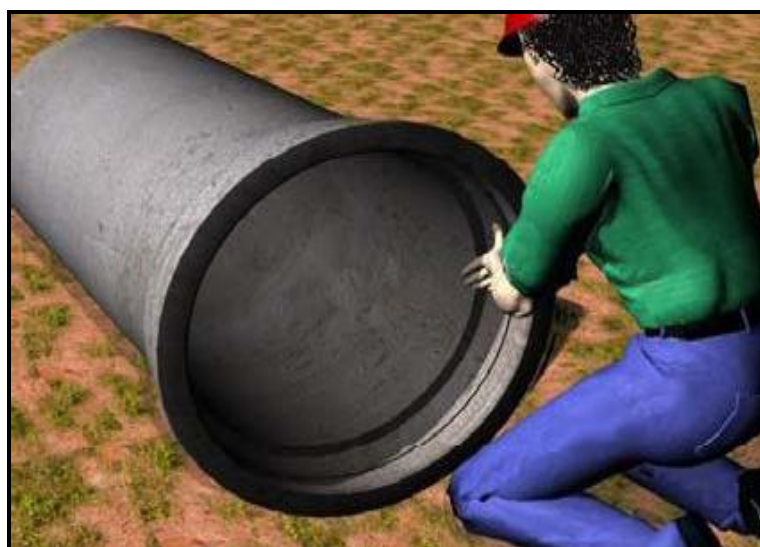
Figura 14 - Lubrificação do anel de borracha
