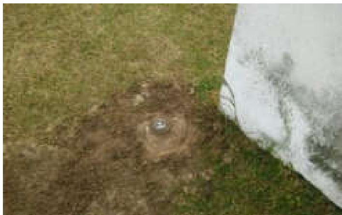
Figura 1 - RN implantado em concreto com chapa metálica
