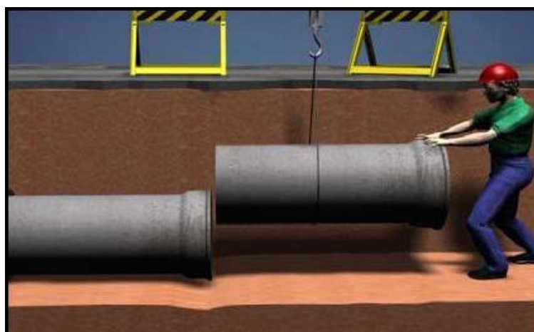
Figura 34 - Acoplamento de tubos de concreto
