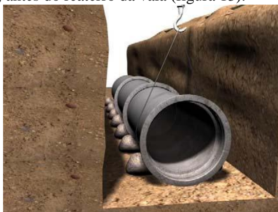
Figura 04– Alinhamento dos tubos com uso de calços
