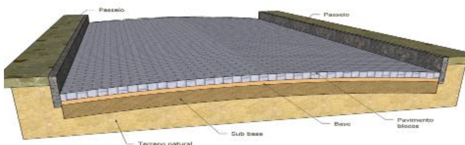
Figura 7 - Desenho esquemático do perfil transversal da pavimentação com blocos
