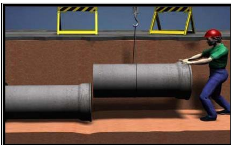
Ilustração 24 – Acoplamento de tubos de concreto
