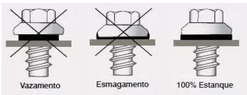
Detalhe do aperto do parafuso da telha
