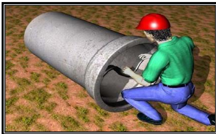
Figura 7 - Colocação do anel de borracha
