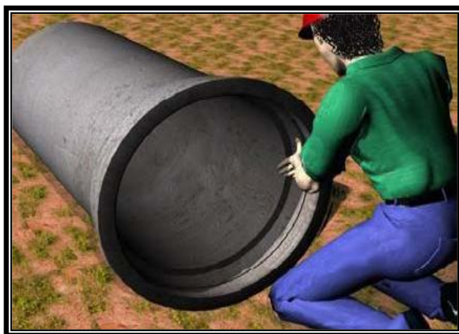
Figura 8 - Lubrificação do anel de borracha
