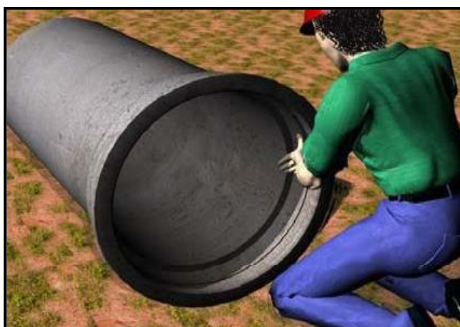
Figura 24 - Lubrificação do anel de borracha
