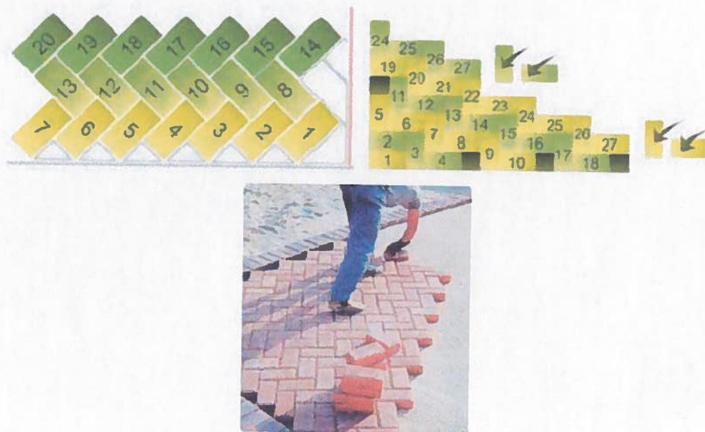
Figura 18 - Padrão de assentamento tipo espinha de peixe.
