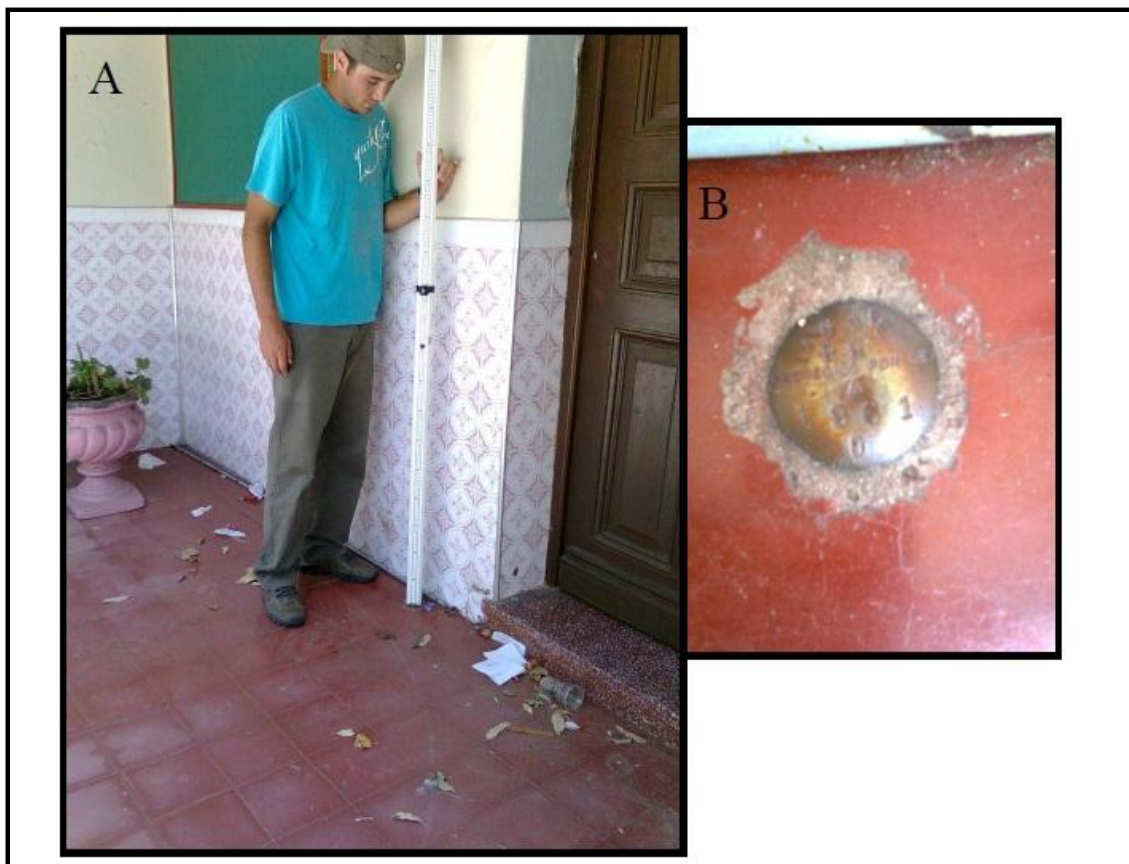
Ilustração 2: (A) - Estação Altimétrica (1961 – D), chapa cravada padrão IBGE na Porta da Igreja Sagrada Família Cassino. (B) – Chapa cravada identificando Estação Altimétrica.
