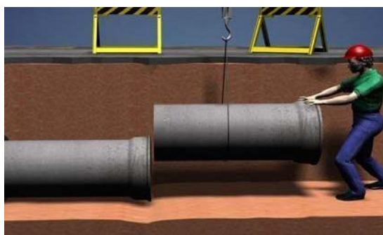
Figura 08. Acoplamento de tubos de concreto
