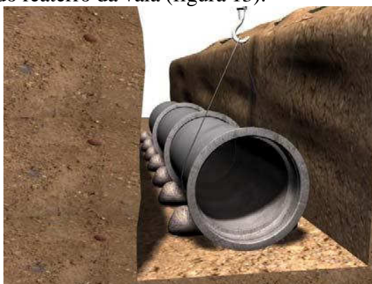
Figura 13– Alinhamento dos tubos com uso de calços
