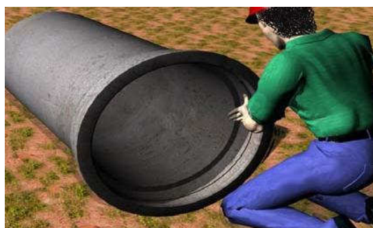
Figura 11 - Lubrificação do anel de borracha
