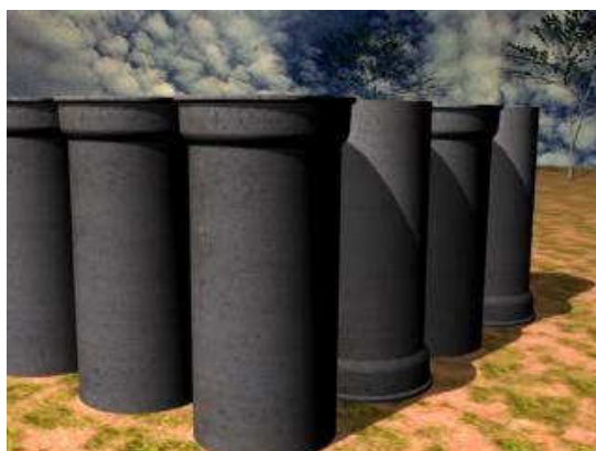
Figura 09. Tubos estocados na posição vertical
