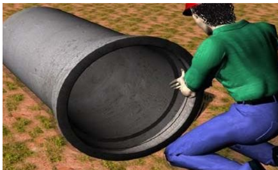
Figura 10 - Lubrificação do anel de borracha
