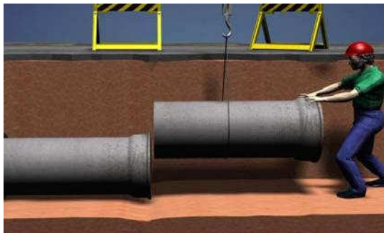
Figura 12– Acoplamento de tubos de concreto
