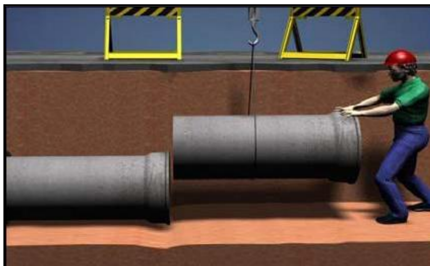
Figura 14 – Acoplamento de tubos de concreto
