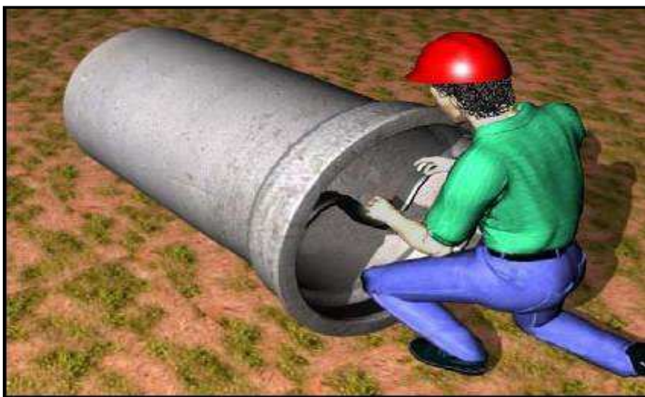
Figura 11 - Colocação do anel de borracha
