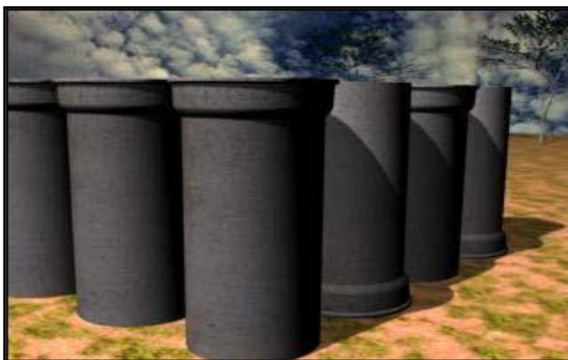
Figura 11 - Tubos estocados na posição vertical
