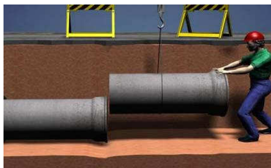
Figura 12– Acoplamento de tubos de concreto
