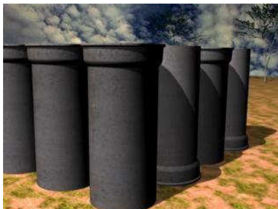
Figura 09. Tubos estocados na posição vertical
