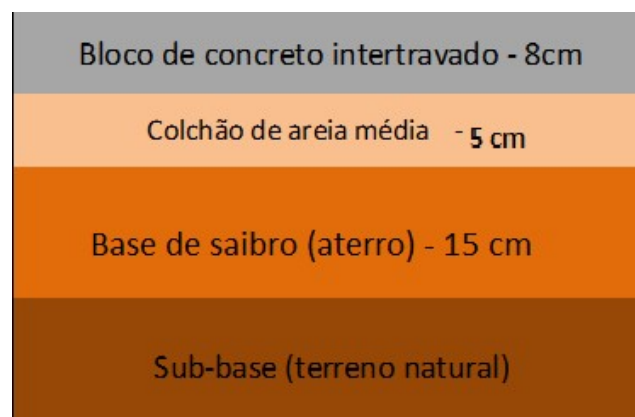
Figura 11 - Camadas do pavimento de bloco de concreto intertravado
