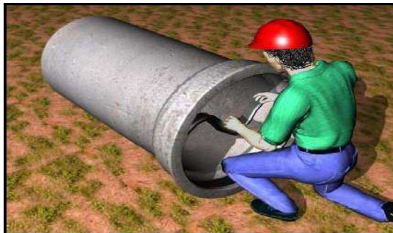
Figura 27 - Colocação do anel de borracha
