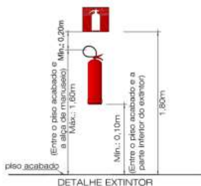
Figura 29 - Imagem de referência – Detalhe extintor fixado na parede.
