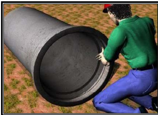
Figura 13 - Lubrificação do anel de borracha
