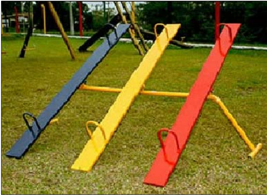
GANGORRA DESCRIÇÃO: FABRICADA COM TUBOS DE AÇO DE 2" x 2,65 E 7/8 x 2 E MADEIRA DE LEI DE 20 CM X 4 CM X 290 CM E PARAFUSO ZINCADO DE 1/2 x 9" PINTADA COM TINTA ESMALTE INDUSTRIAL E FUNDO ANTI-CORROSIVO. MEDINDO 2.90 x 0.65 x 2.50.IDEAL PARA CRIANÇAS DE ATÉ 12 ANOS. ALTURA: 0.65M LARGURA: 2.50M COMPRIMENTO: 2.90M
