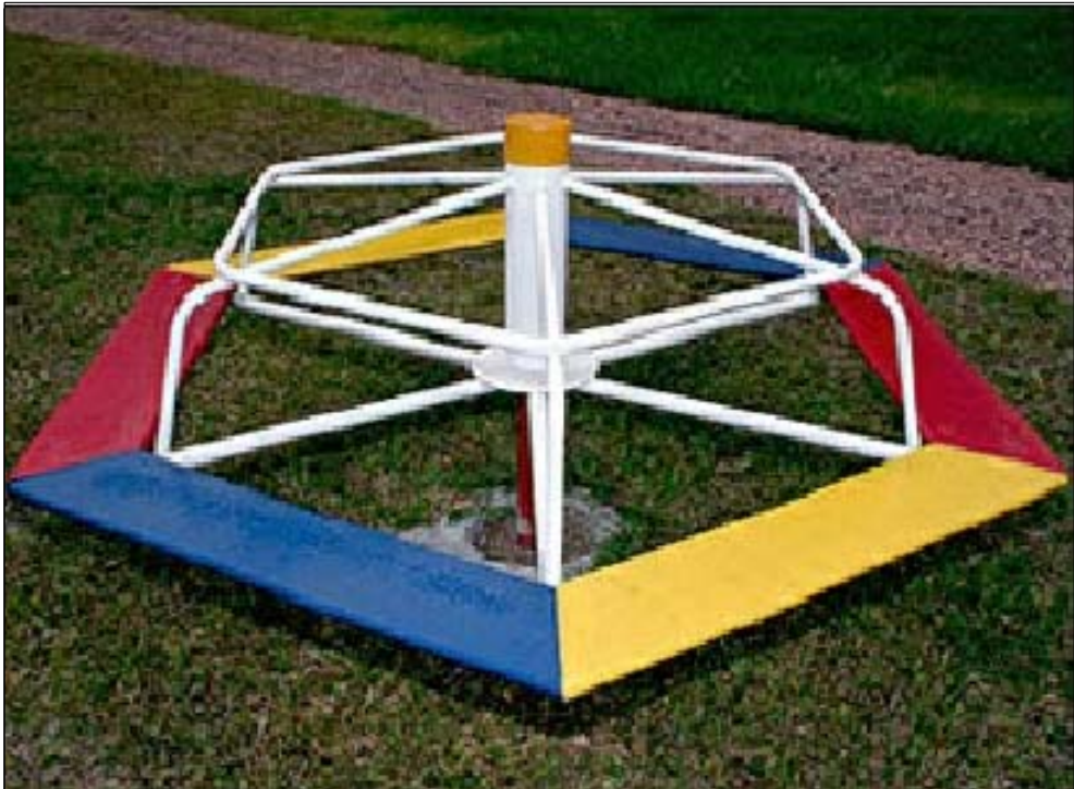
GIRA-GIRA DESCRIÇÃO: FABRICADO EM TUBOS DE 5" x 2,65 ; 2 1/2 x2,65 ; 7/8 x 2 E ASSENTOS EM MADEIRA DE LEI DE 0,20 CM X 100 CM, FIXADOS COM PARAFUSO FRANCÊS ZINCADO, POSSUINDO UM ROLAMENTO CÔNCAVO DE 60 E OUTRO BLINDADO DE 25 MM. PINTADO COM TINTAS ESMALTE INDUSTRIAL E FUNDO ANTI CORROSIVO.MEDINDO 1,94 M DE DIÂMETRO E 1 M DE ALTURA.IDEAL PARA CRIANÇAS DE ATÉ 12 ANOS. ALTURA: 1.00M LARGURA: 1.94M
