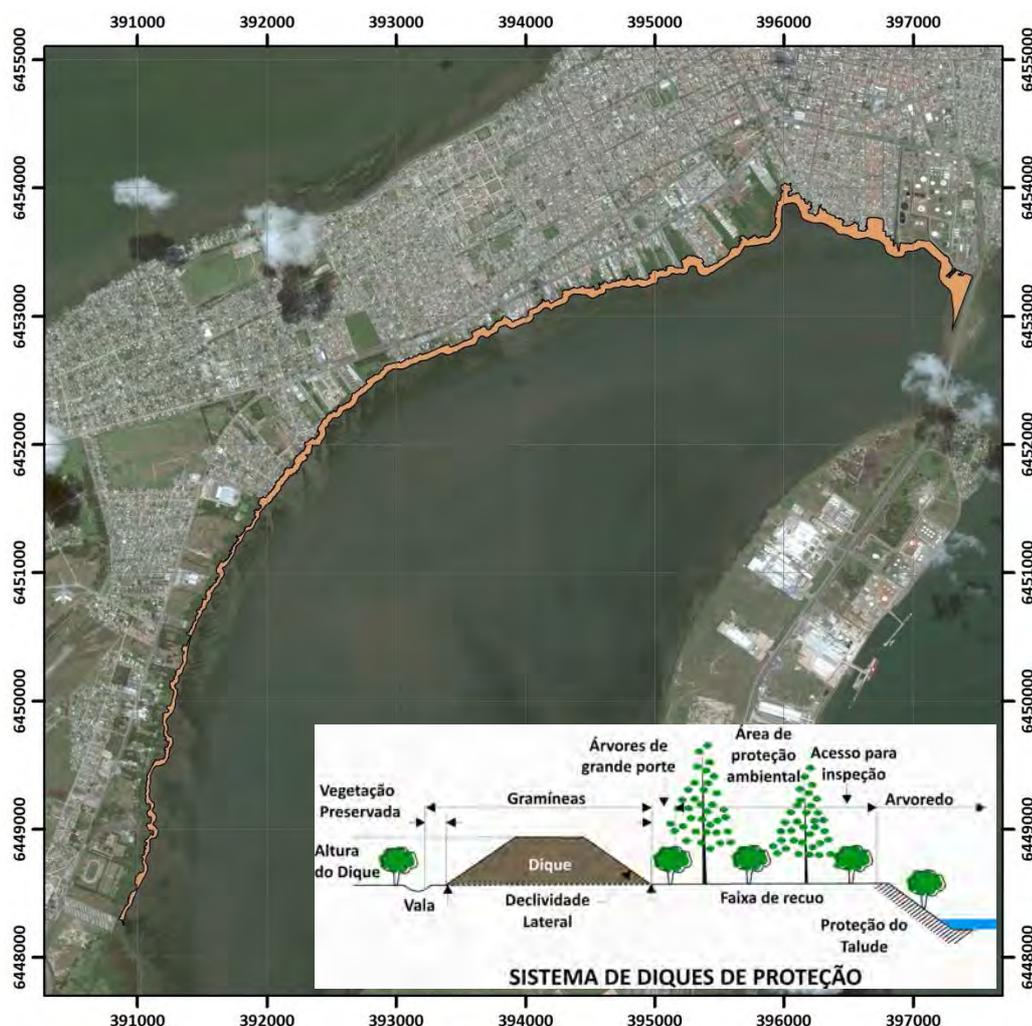
Figura 5.3: Ilustração esquemática do aterro para revitalização da orla do Saco da Mangueira
